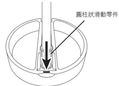
4 轉鬆支架的鎖定部，將夾子的接合零件嵌入直到發出聲響，然後轉緊鎖定部。
